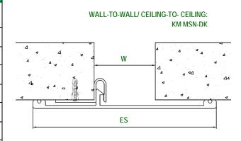
WALL-TO- PENDICULAR WALL/ CEILING-TO-WALL : KM MSN-QDK
